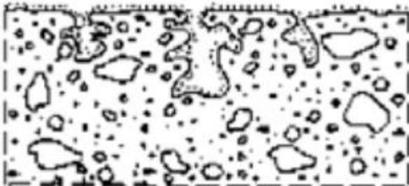
*Esquema de una impregnación hidrófoba*
