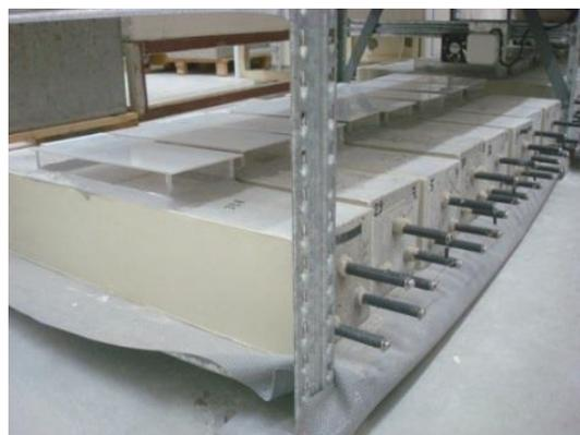
Tras finalizar el proceso de curado de las muestras en una cámara húmeda durante 28 días y su posterior almacenamiento durante un mes a una temperatura de 23°C aproximadamente, se ejecutó una ranura de 5 mm (0,2 in) de profundidad y 3 mm (0,1 in) de ancho en la parte superior de las piezas. El recubrimiento de hormigón resultante, medido por debajo de la muesca, fue de 38 mm (1,5 pulgadas).
